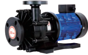
QHXI Series (50/60 Hz) 최대유량 : 1,175L/min 최대수두 : 44m 주요소재 : 폴리프로필렌계열 PPH/PVDF/CFRETFE 유체온도범위 : 0~80℃ (PPH) 0~90℃ (PVDF) -10~120℃ (CFRETFE)
