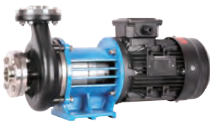
QWWI Series (50/60 Hz) 최대유량 : 830L/min 최대수두 : 48m 주요소재 : 스테인레스 SUS304/ SUS316 유체온도범위 : -196~420℃
