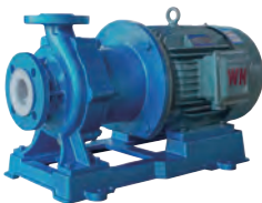
QBFI Series (50/60 Hz) 최대유량 : 5,350L/min 최대수두 : 93m 주요소재 : 탄소강 F46 유체온도범위 : -20~100℃ (F46) 0~100℃ (CFRETFE) 고온사양 고객맞춤 가능
