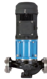
QLLI Series (50/60 Hz) 최대유량 : 1,800L/min 최대수두 : 83m 주요소재 : 스테인레스 SUS304/ SUS316 유체온도범위 : -196~420℃
