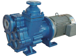
QBFZI Series (50/60 Hz) 최대유량 : 1,000L/min 최대수두 : 36m 주요소재 : 탄소강 F46 유체온도범위 : -20~100℃ (F46) 고온사양 고객맞춤 가능
