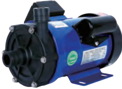
MDI Integrated Series (50/60 Hz) 최대유량 : 100L/min 최대수두 : 13m 주요소재 : 폴리프로필렌계열 PPH/PVDF/CFRETFE 유체온도범위 : 0~80℃ (PPH) 0~90℃ (PVDF) 0~100℃ (CFRETFE)
